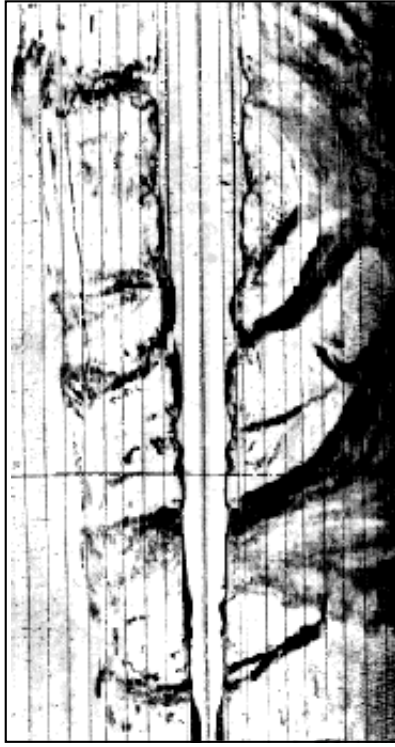
Fig. 2.9b: Enregistrement par écho-sondeur d'une partie du talus est du lac Isli (rectangle dans fig. 9a).
