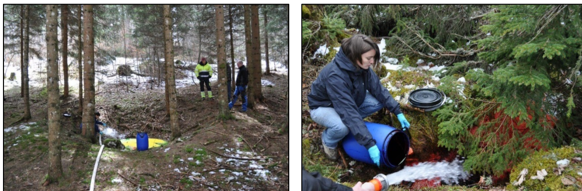
Figure 42: Points d'injection des traceurs : à gauche, injection de l'uranine au Rosset, à droite injection de l'éosine aux Bioles.
