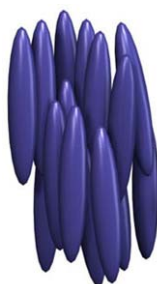
Figure 1.4 Représentation schématique de la phase nématique de cristaux liquides calamitiques.
