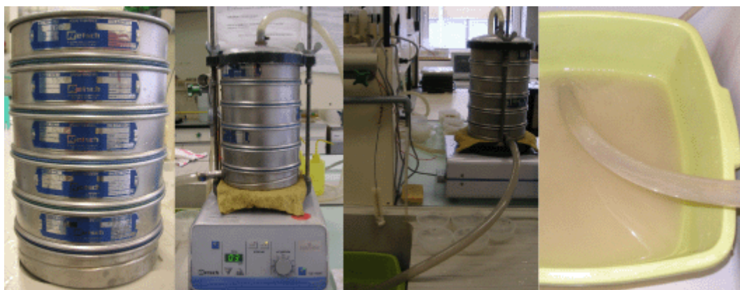
Fig. 14. De gauche à droite : Tamis, tamis et vibreuse (deux photographies), bac de récupération.
