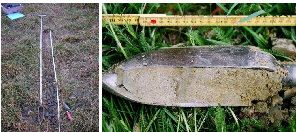
Fig. 5. Tarière à rallonge (gauche) et exemple de sondage (droite).
