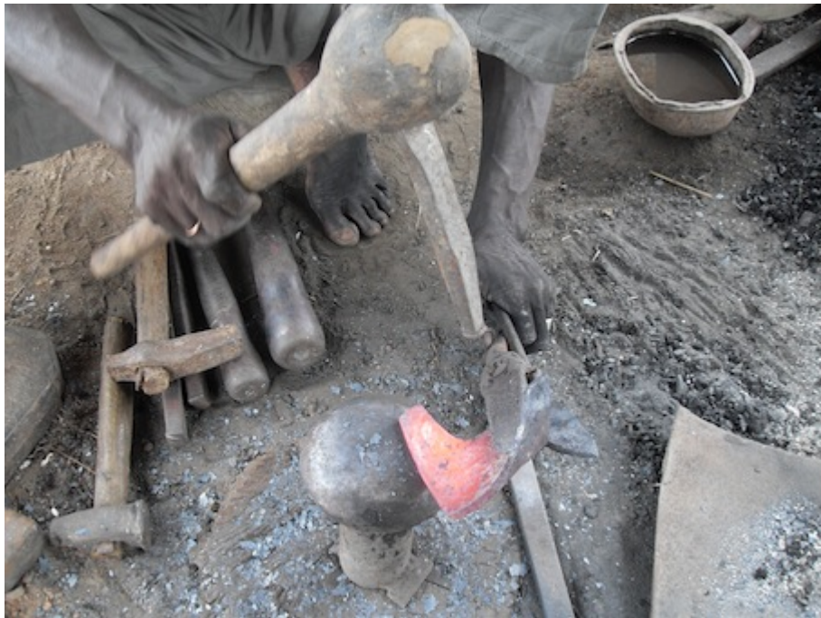
Photo 11 Forgeage d'un col de grande houe
