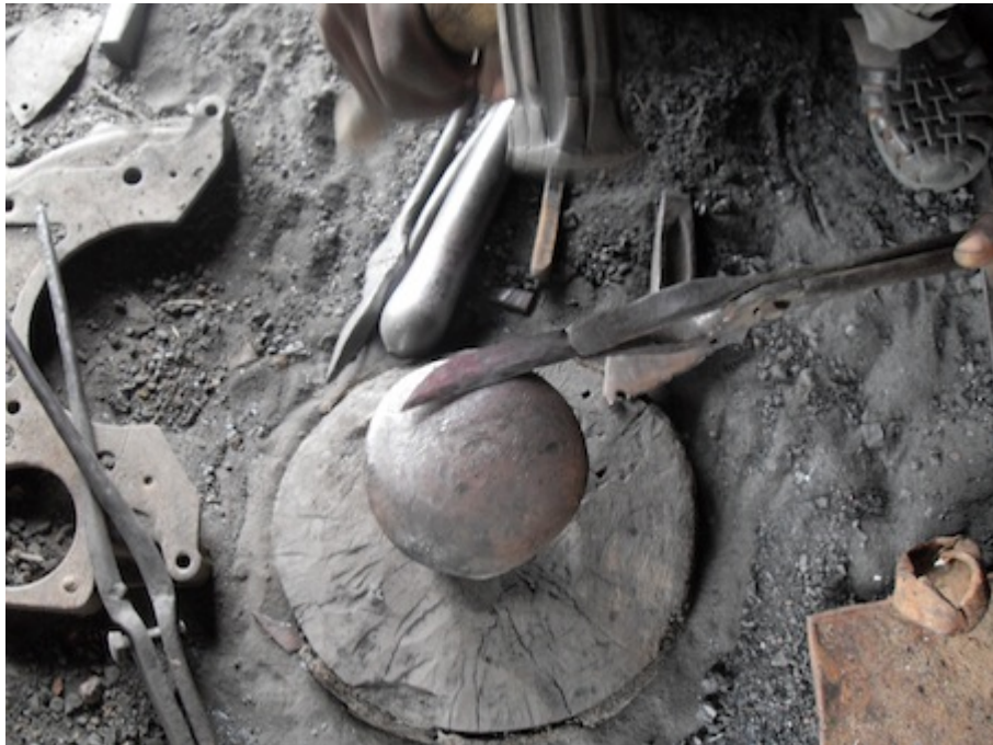
Photo 2 Forgeage d'un petit couteau
