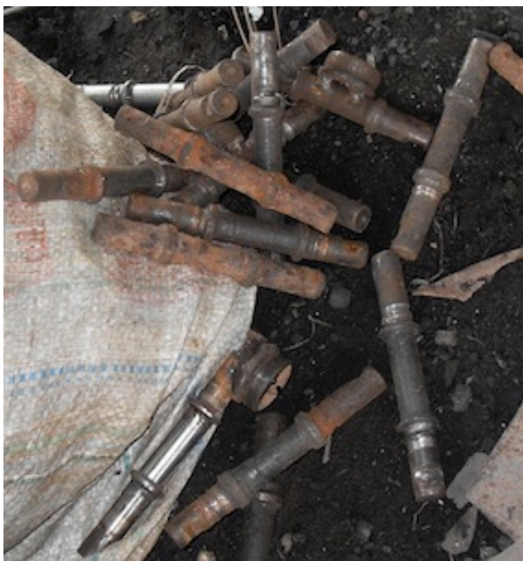
Photo 7 Axes de roues de bicyclette pour fabrication d'outils aratoires
