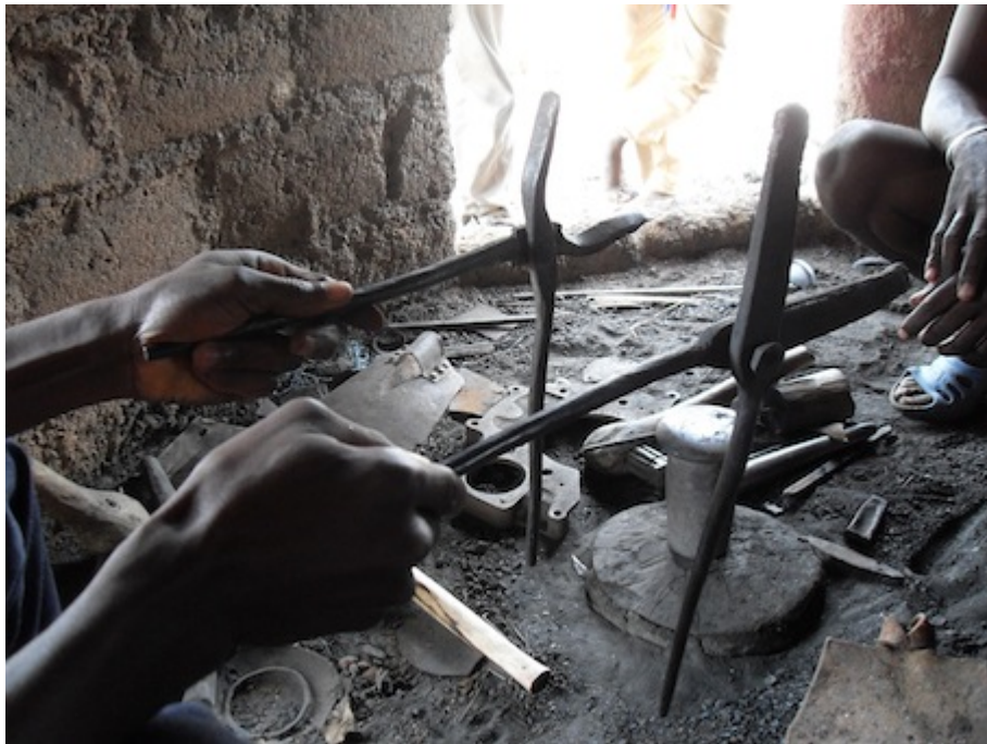
Photo 3 Deux types de pinces (modernes à gauche et traditionnelles à droite)
