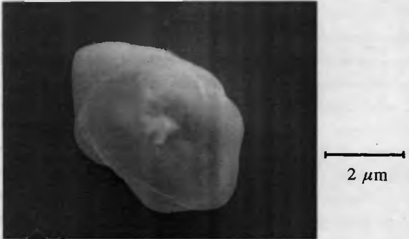
Figure 39: Exemple représentatif de la forme d'une particule de TiC telle qu'on la trouve dans le ruban à l'état coulé (photo au MEB avec le signal des électrons secondaires).
