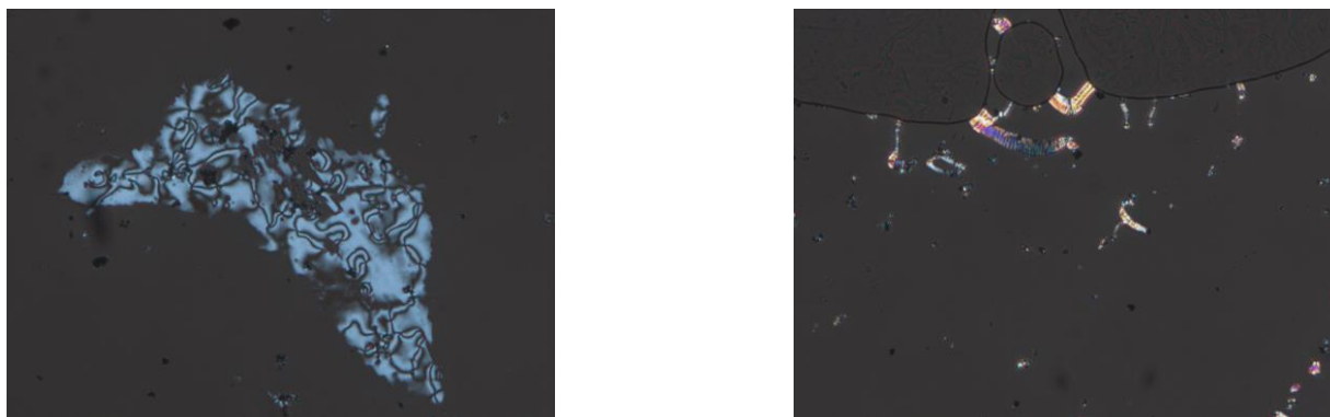
Figure 56. Texture « schlieren » et zones homéotropes de la phase N à 175 °C (gauche) et textures homéotropes et coniques focales de la phase SmA à 104 °C (droite) du composé 50 .
