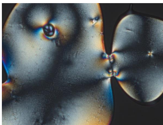
Figure 47. Textures de la phase nématique N à 57.4 °C du composé 44 .
