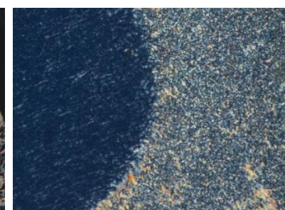
Figure 41. Texture de Grandjean de la phase N* à 89.5 °C (gauche), textures homéotropes et coniques focales de la phase SmA* à 78.5 °C (milieu) et textures « schlieren » et coniques focales de la phase SmC* à 67 °C (droite) du composé 22 .
