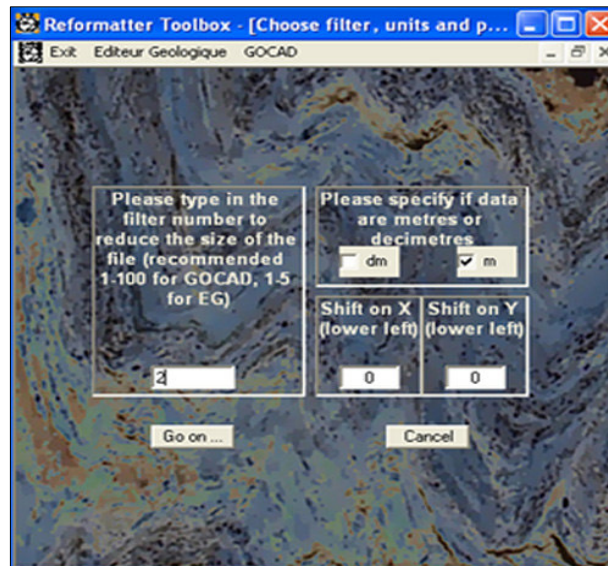
Figure 5.2. : Capture d'écran du programme Reformatter ToolBox . La routine d'export du MNT DHM 2 EG est active, permettant la spécification du filtrage, de l'unité de mesure et d'un possible shift.
